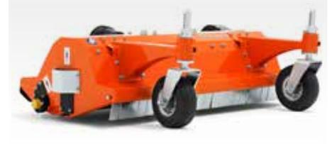
Tondobroyeur à fléaux entraîné par prise de force. Nouvelle conception avec engrenage conique renforcé, hauteur de coupe augmentée et performance améliorée dans la végétation dense. Les roues de support avant sont pivotantes et increvables. Largeur de travail 120 cm. Exige un contrepooids.
