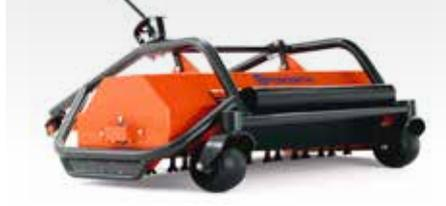
Tondo-broyeur à fléaux robuste et fiable, pour les surfaces couvertes d'herbe touffue et de taillis bas. Doté d'un renvoi d'angle très résistant pour une durée d'utilisation maximale. Largeur de travail 100 cm.
