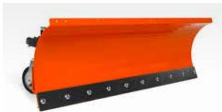
Lame à neige en acier robuste. Réglage de l'angle hydraulique et largeur de travail de 140 cm. Exige un kit hydraulique et un contrepoids. Pour répondre aux exigences sur différents marchés, la lame doit être complétée par des patins et un racleur ou par des roulettes d'appui et un racleur en caoutchouc.
