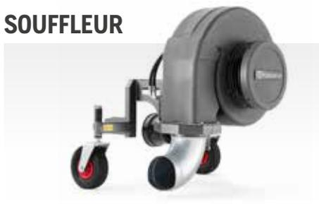
Souffleur entraîné par prise de force pour le nettoyage des grandes surfaces ouvertes. Ventilateur puissant et silencieux développant un débit d'air de 80 m<sup>3</sup>/min. Sortie d'air orientable à 360 degrés depuis le siège. Exige un kit hydraulique.
